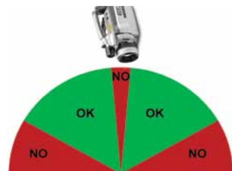
Empfohlener (grün) bzw. zu vermeidender (rot) bei thermografischen Untersuchungen.
